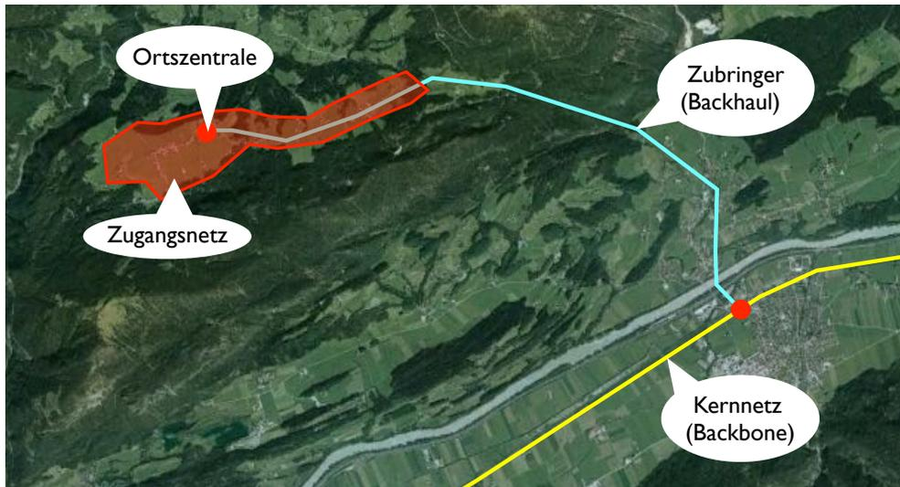
Abbildung 2: Zugangsnetz mit Anbindung an das Kernnetz
