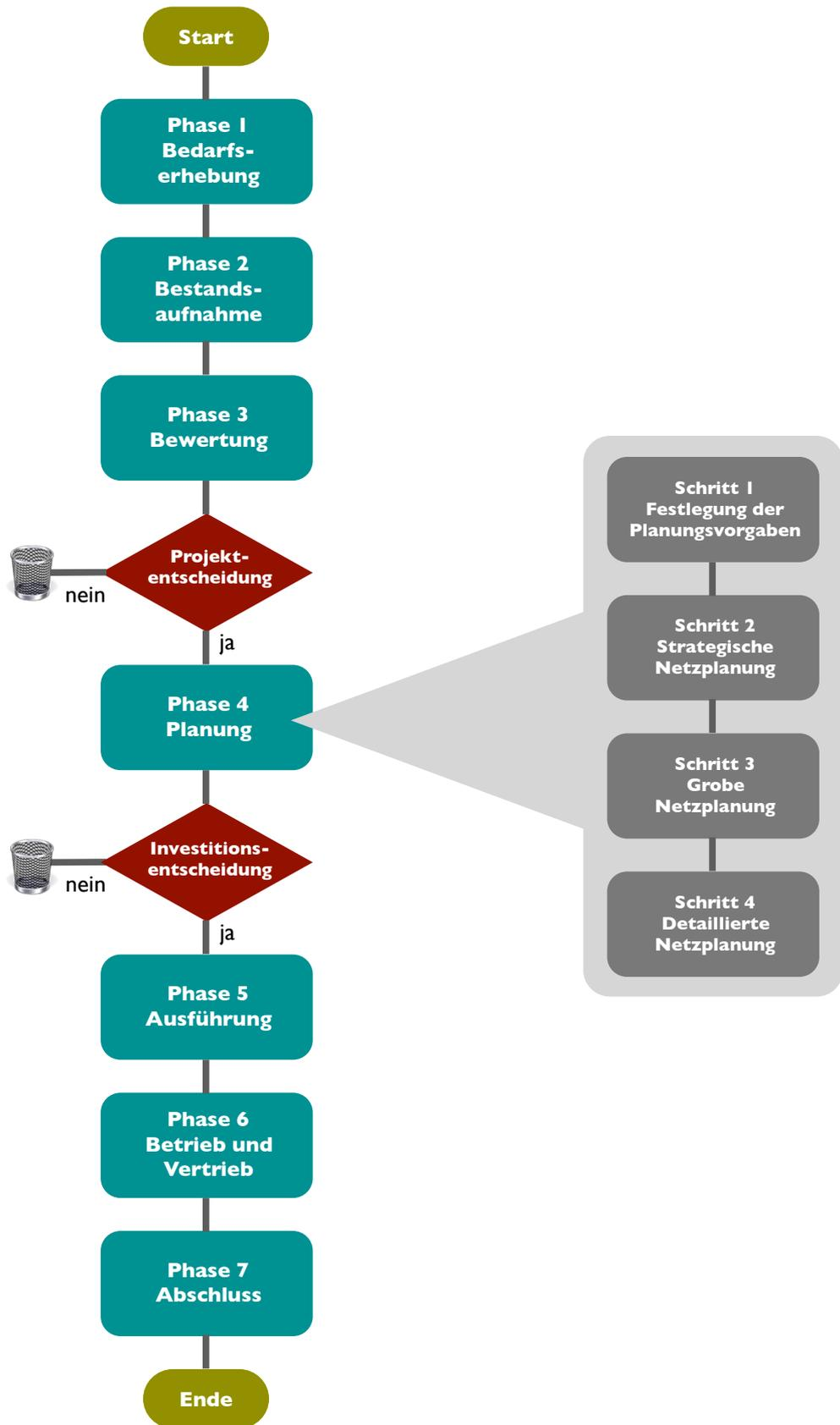
Abbildung 7: Phasenmodell für den Projektablauf und die Planung
