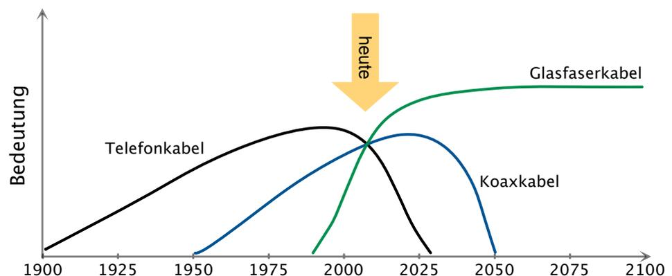
Abbildung 1: Zeitliche Entwicklung der Zugangstechnologien im Festnetz
