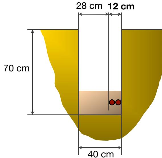
Abbildung 42: Beispiel für Mitverlegung
