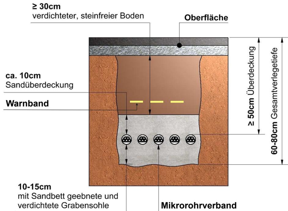
Abbildung 35: Typischer Einbau von Mikrorohrverbänden
