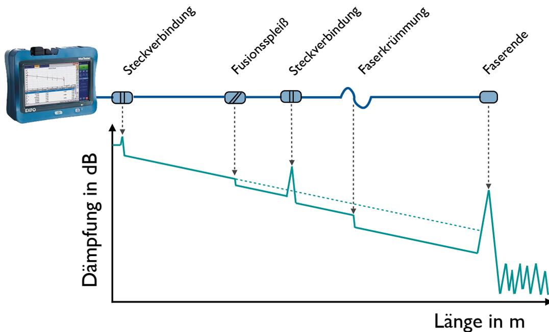
Abbildung 54: Prinzipielles Ergebnis einer OTDR-Messung
