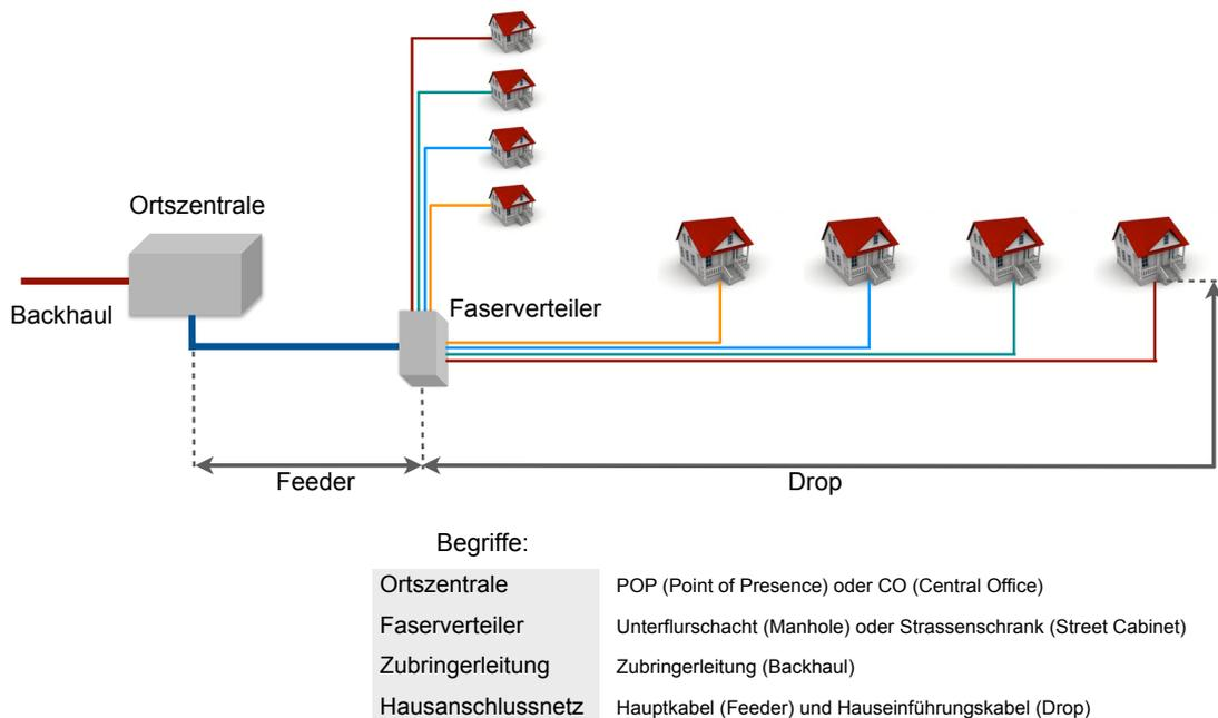
Abbildung 5: Referenzmodell eines optischen Zugangsnetzes
