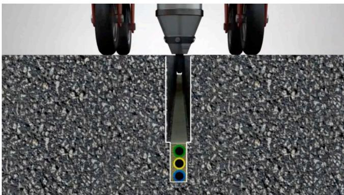
Abbildung 38: Aufbau Nano-Trench
