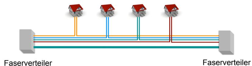
Abbildung 33: Versorgung eines Gebäudes mit zwei Hauseinführungskabeln
