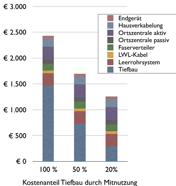
In diesem Beispiel variieren die Tiefbaukosten durch Mitverlegung (100 % ohne Mitverlegung, 50 % und 20 % Kostenanteil nach Mitverlegung). Da der Tiefbau einen dominanten Kostenanteil ausmacht, ist die Mehrfachnutzung einer Künette unbedingt anzustreben.
