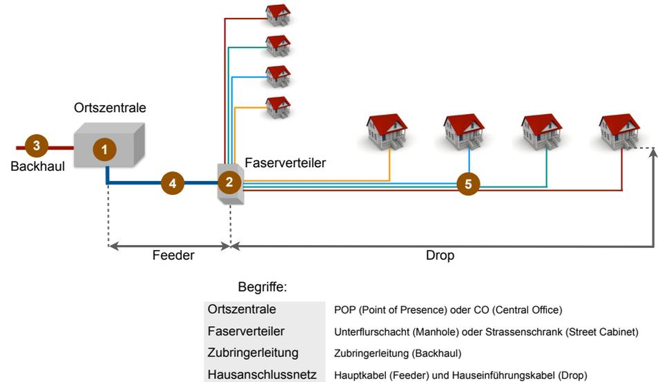
Abbildung 12: Elemente eines optischen Zugangsnetzes
